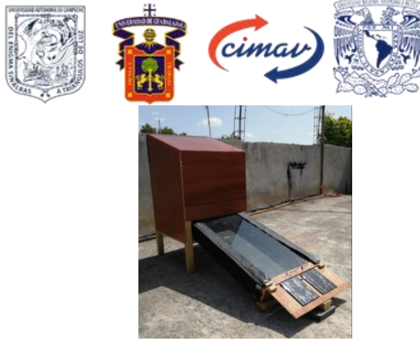
Figura 8. Deshidratador solar indirecto por convección forzada. Fuente: Propia
