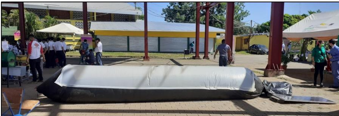
Fig. 1. Prototipo de secador solar inflable, ISD, caracterizado como secador tipo túnel semicilíndrico, híbrido directo y activo, de baja temperatura.
