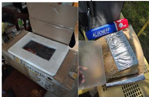
Figura 4 Construcción del dispositivo, aislamiento térmico II. Elaboración propia.
