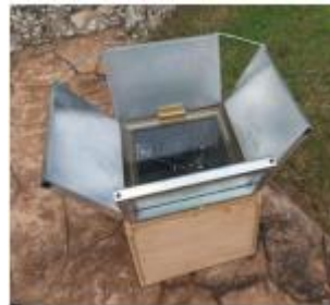
Figura 2. Horno solar B con 4 aletas aleta reflectante
