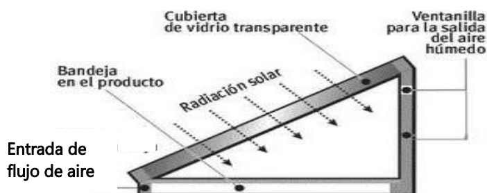
Ilustración 13. Configuración del calentador solar directo
