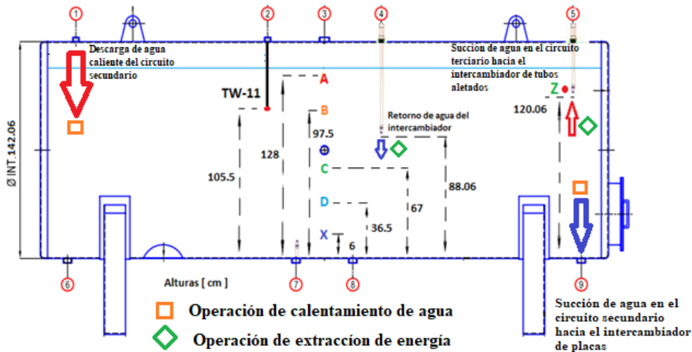
Figura 45 Instrumentación al interior del tanque de almacenamiento de energía.
