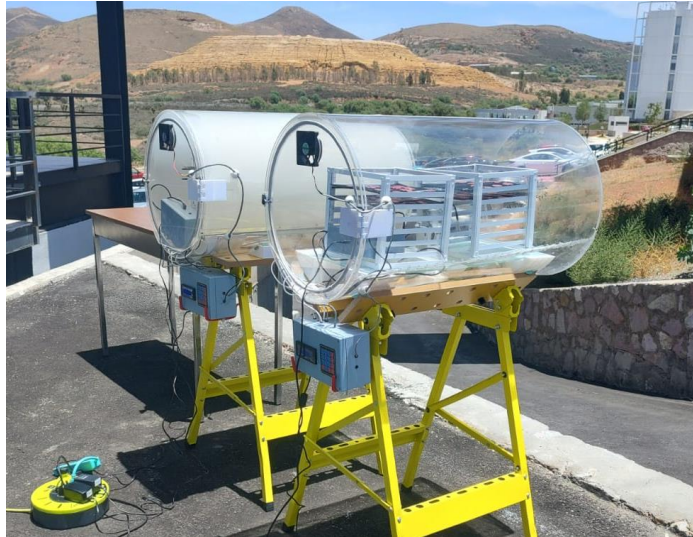
Figura 5 Secador solar con control de irradiancia y secador solar cilíndrico
