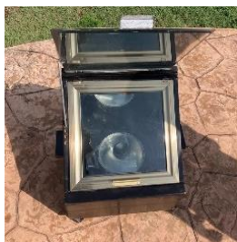
Ilustración 1. Cocina solar tipo caja con espejo reflector
