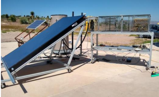
Figura 1. Secador solar mixto tipo túnel
