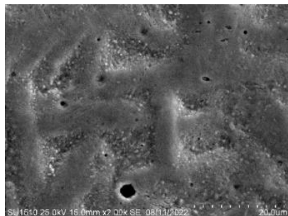
Figura 9. Corrosión por picadura al 40%
