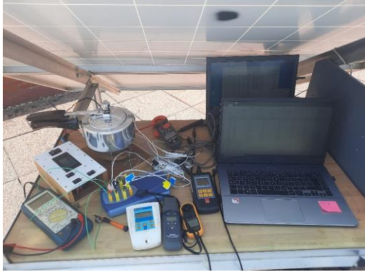
Figura 3. Izq. Puesto de trabajo bajo los paneles fotovoltaicos, mostrando la olla desnuda, unidad de control, la instrumentación, "data logger" y ordenadores para monitorización. Der. Irradiancia a lo largo del ensayo de calentamiento 07/07/2023.
