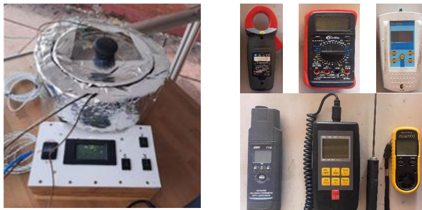
Figura 2. Izq. Unidad de control, olla a presión aislada e instrumentada con termopares. Der. Instrumentación usada: pinza amperimétrica, multímetro, solarímetro, termómetro de infrarrojos, sensor de Pt100 y anemómetro de mano.
