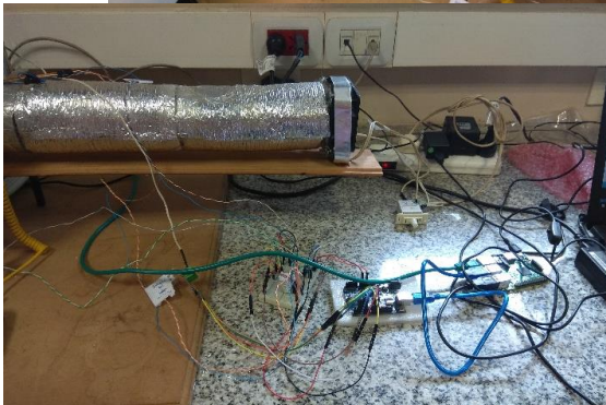
Figura 1 Esquema de disposición de sensores y fotografías del secador de laboratorio. Fuente: Elaboración propia.
