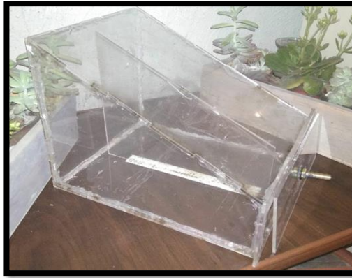
Figura 3. Construcción de Prototipo II de Secador solar con vacío.
