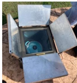
Ilustración 2. Cocina solar tipo caja con aletas reflectoras
