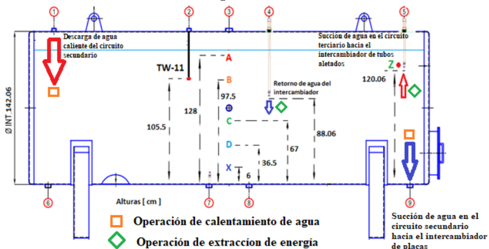
Figura 34 Instrumentación al interior del tanque de almacenamiento de energía.
