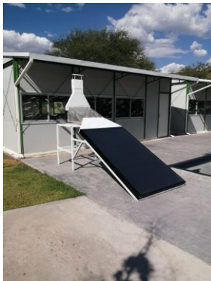
Figura 13 Secador solar mixto
