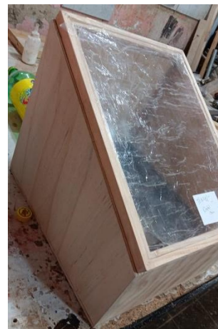
Ilustración 13. Configuración del calentador solar directo
