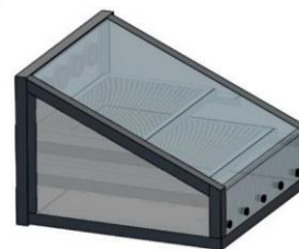
Figura 13 Secador solar directo tipo gabinete
